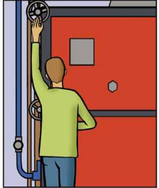
Después de un corto período de calentamiento con la puerta del horno entreabierta, para eliminar las partículas de agua que aún puedan contener las piezas, se cierra la puerta.
