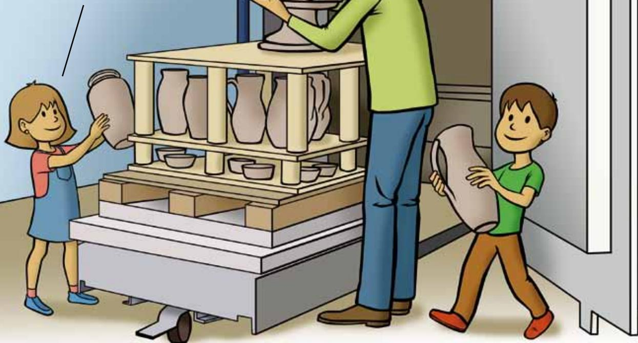
Cuando ya tenemos colocadas todas las piezas, las introducimos en el interior del horno empujando la estructura, que se desliza sobre una guía.
