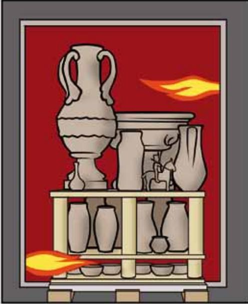
Ahora debemos encender el horno. Éste tiene un quemador en la parte frontal inferior izquierda y otro en la parte trasera superior derecha y está diseñado para que la temperatura se distribuya uniformemente en su interior.
